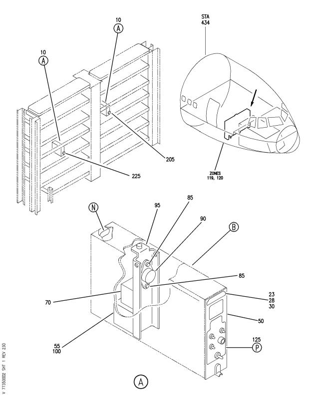
EQUIPMENT INSTL-ELECTRONIC EQPT CTR E1/E2 RACK (ELECTRONIC ENGINE CONTROL MONITORING SYSTEM ONLY)
