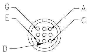
CONNECTOR PART NO.: MS3102A22-20P MATING CONNECTOR: MS3106A22-20S
