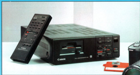
Video Still Recorder samt Kamera - alt foregår pr. diskette
