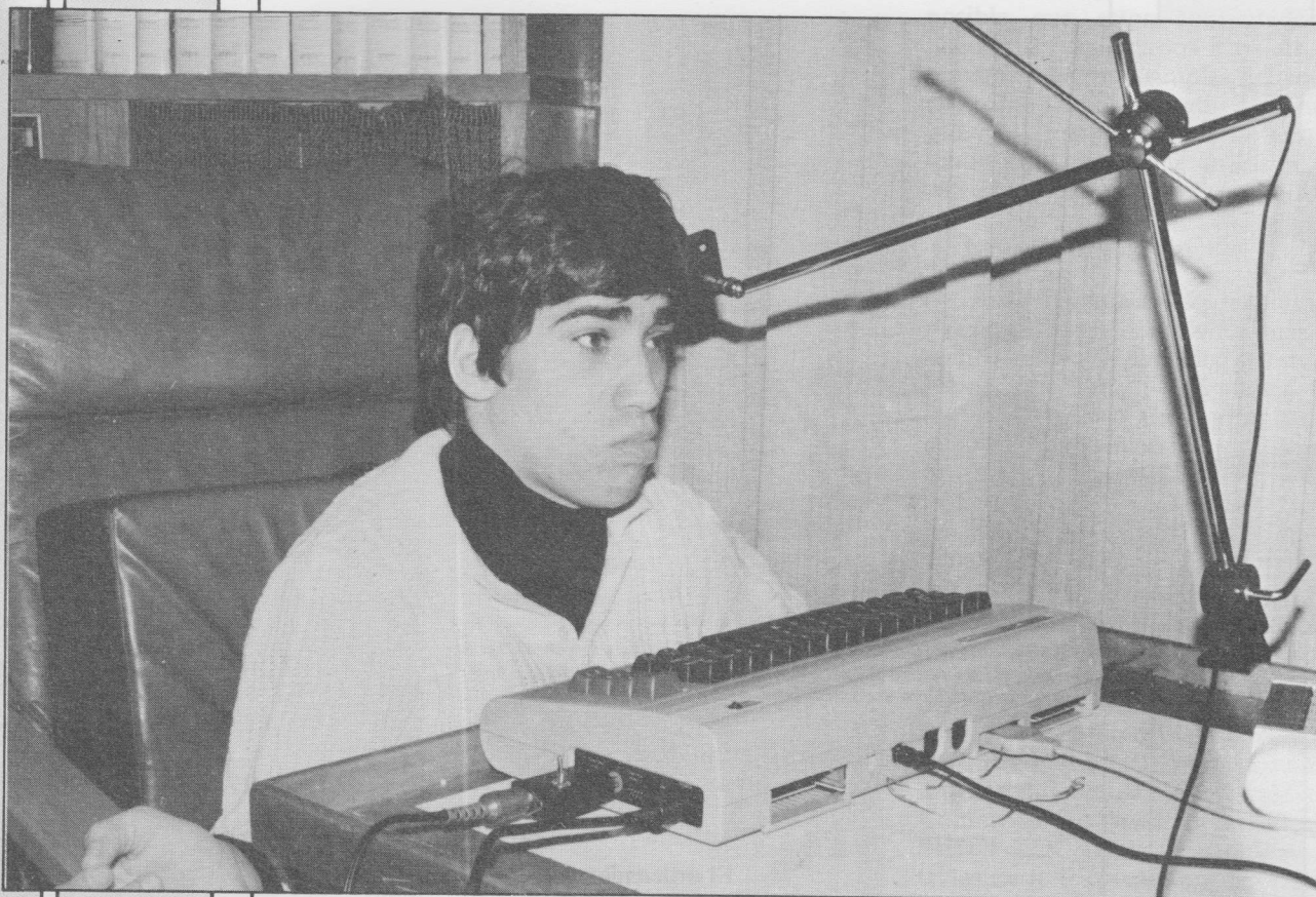
Jaime Montornes accionando un conmutador conectado al port 1 de Joystick del CBM-64.
