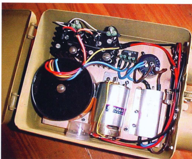
Binnenwerk Kkw.E.e. omvormer.
