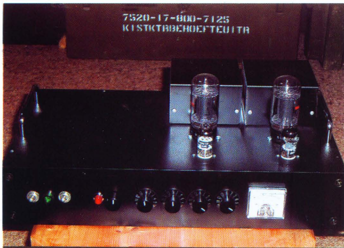
De laagfrequent versterker met vooraan de buizen 2 x ECC 83 en achteraan 2 x 6L6.
