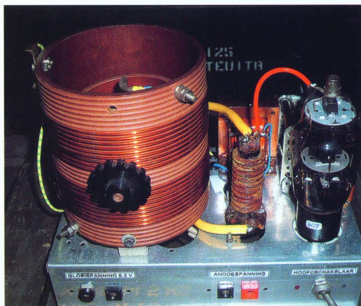
Achterzijde van het H.F.-zendertje, de variabele koppelwinding van de antenne zit in de spoel.
