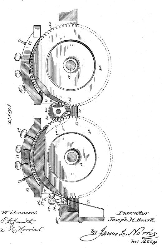
MACHINE FOR MAKING PINS FOR PIN FASTENERS.
