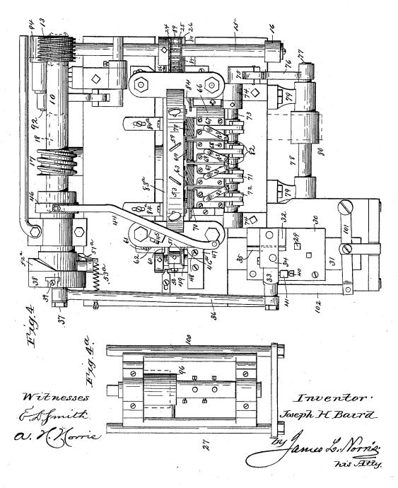
MACHINE FOR MAKING PINS FOR PIN FASTENERS.
