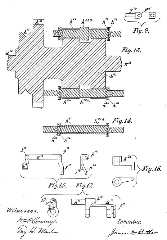
SHUTTLE BOX OPERATING MECHANISM FOR LOOMS.
