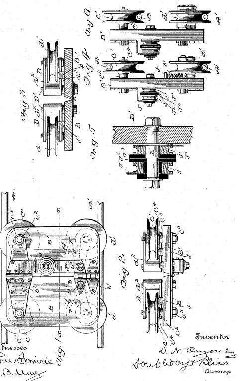
D. N. OSYOR. TROLLEY FOR ELECTRICAL CONDUCTORS.
